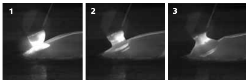
IAC - Faldende svejsning af rodsøm i fjernvarmerør. Hastigheden er væsentlig forøget i forhold til traditionel stigende svejsning.
