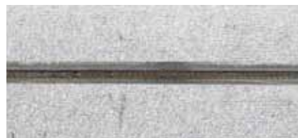
Galvaniseret sort stål – Plasma-smelte i 0,5 mm godstykkelse
