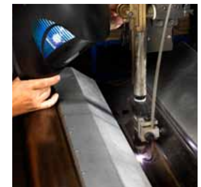
Plasma i langsømsautomat - rustfaste svøb
