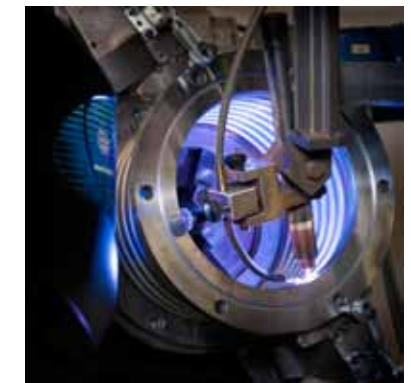
Svejsning i rustfast stål - vibrationsdæmper til røggassystem
