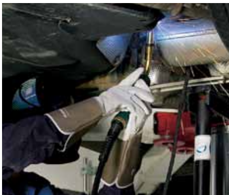
Trimning af svejseparametre direkte fra Dialog brænder
